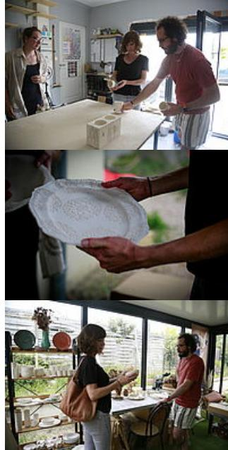
Dans un premier temps, c'est dans leur garage qu'ils ont installé leur atelier. Marion y façonne les modèles qu'elle a imaginés, Quentin réalise des moules en plâtre pour leur production. Un mélange d'argile et d'eau, la barbotine, est coulée dans les moules. Après la cuisson, vient l'émaillage, réalisé au pinceau, par pulvérisation ou bien par trempage. Au final : une vaisselle design et fine, qui marie étonnamment la résistance et la légèreté.
